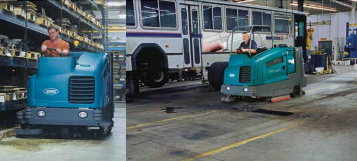
Die erste vollständig integrierte Kehrsaug-/Scheuersaugmaschine M20 wurde für eine verlässliche Reinigung im industriellen Einsatz entwickelt, wo Scheuersaugen, Kehren oder beides gleichzeitig erforderlich ist.
